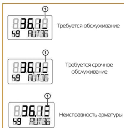
Рис. 2. Пример индикации кода ошибок при ручной диагностике
